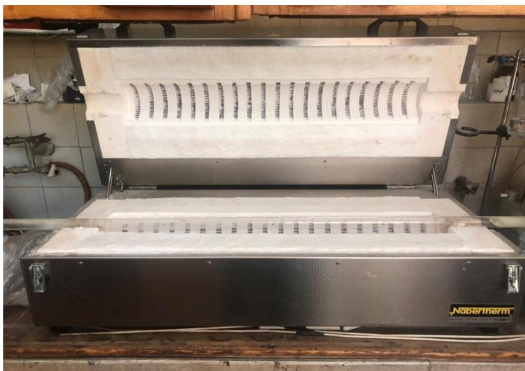
Рисунок 6 – Двухзонная печь NABERTHERM для сульфидирующего обжига
